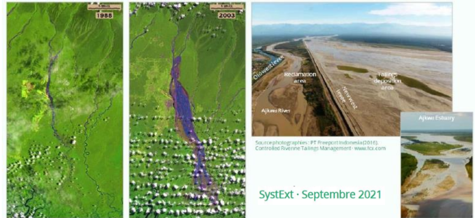
Figure 47 : Impacts des déversements de résidus miniers dans la rivière Ajkwa, située en aval du site minier de Grasberg, Indonésie (à gauche) Images satellites Landsat montrant le réseau hydrographique en 1988 (environ 5 ans après le début des déversements) et en 2003 (échelle : 5 miles = 8 km) (SkyTruth · cc by-sa-nc 2.0) (à droite) Rivière Ajkwa et son estuaire recouvert de résidus miniers (Source : PT Freeport Indonesia, 2016 · www.fcx.com)
